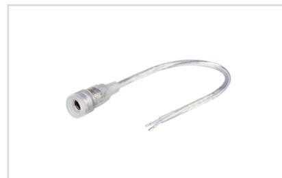
Артикул 022354 Круглый герметичный разъем DC 2-pin MAMA для соединения отрезков одноцветных светодиодных лент. Корпус IP65. Провод 20AWG 15 см. Максимальный допустимый ток 3А.
